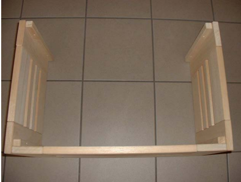
Abb.2 Rahmenstücke mit beiden Verbindungsleisten verschraubt
